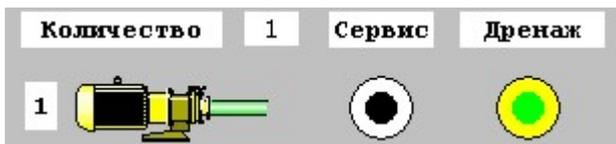
Кнопка дренажа и труба возле насоса светится зеленым – означает, что выбрана автоматическая функция дренажа. Насос пока не включен, но выбран для включения.
