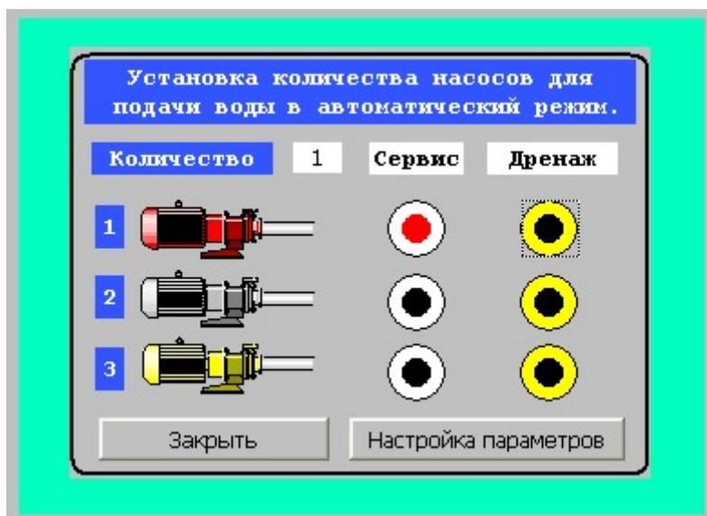
Попасть в меню оперативного управления насосами подачи воды можно из главного технологического окна (рис 1.) нажав на кнопку «Run» или из меню управления функциями танков (см. гл 2.4)
