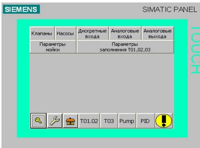
Меню предоставляет возможность точной калибровки значений датчиков температуры, кислотности, датчиков уровня танков воды, устанавливать параметры полевого оборудования. Выставлять задержки на физическое включение/выключение клапанов, насосов. Можно выставлять уровни заполнения танков водой, а также изменять параметры мойки танков T01, T02.
