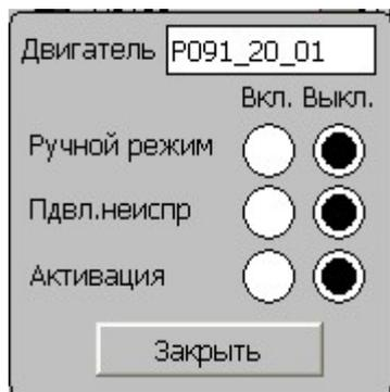
Ручной режим переводит устройство в режим непосредственного ручного управления. Использование этого режима крайне нежелательна т.к функции использующие данное оборудование в автоматическом режиме нельзя будет запустить, или если они уже запущены, то произойдет приостановка функции.
