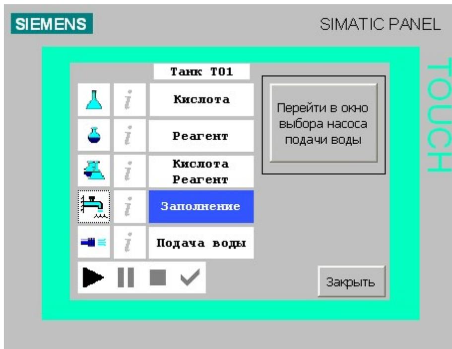
Рис. 6 Меню выбора функции танков T01, T02.
